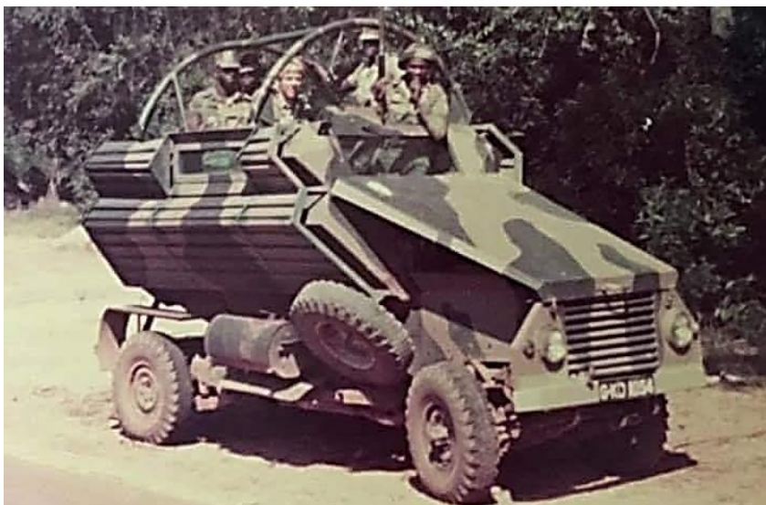
ФОТО 11.6. Южнородезийский броневедомитель Kudu, созданный на шасси автомобиля Land Rover
