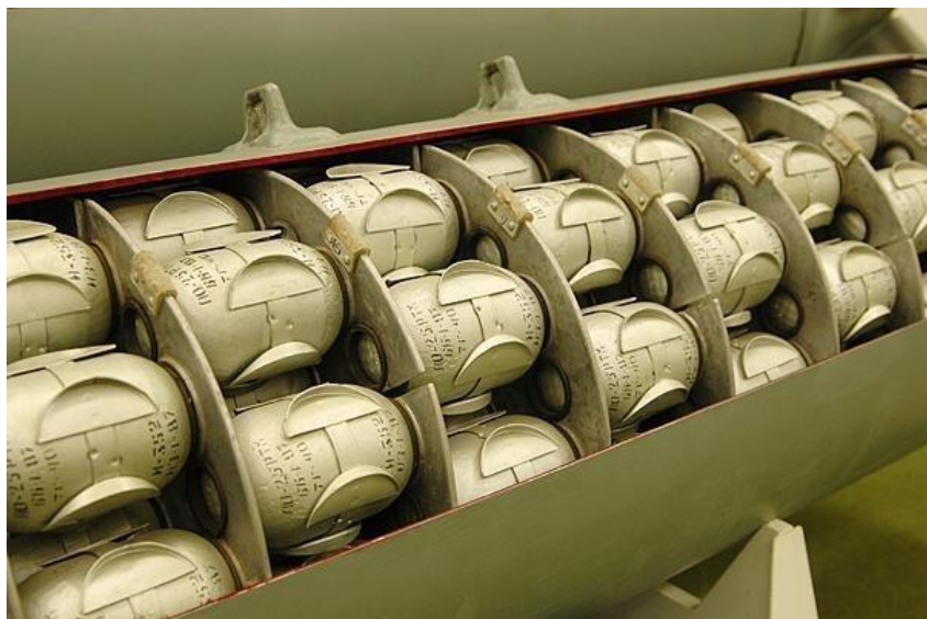
ФОТО 12.1. Разработанные в СССР осколочные боевые элементы АО-2.5 в разовой бомбовой кассете
