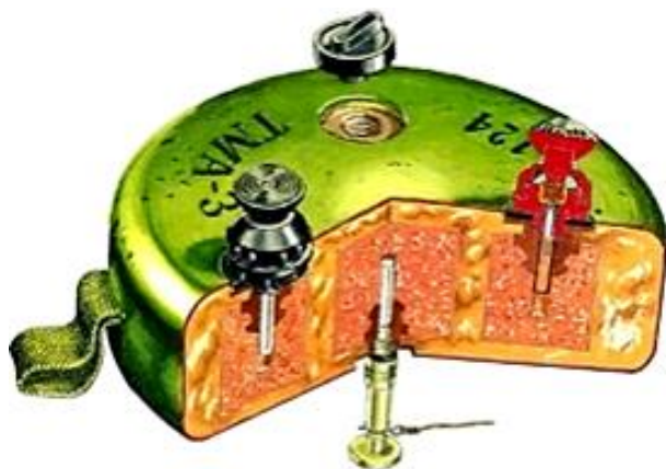
ФОТО 6.106. Противотанковая противогусеничная мина ТМА-3
