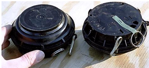
ФОТО 6.42. Противопехотная нажимная мина фугасного действия РРМ-2 (ГДР)
