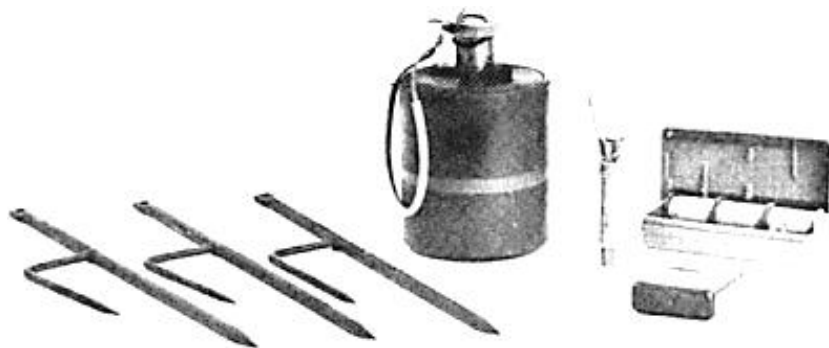
ФОТО 6.2. Израильская противопехотная выпрыгивающая мина осколочного действия №12
