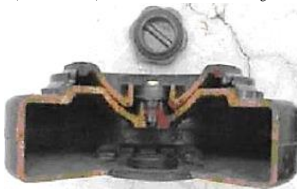
ФОТО 6.94. Противотанковая противогусеничная мина РТ Мi-Ва-III (Чехословакии) // www.humanitarian-demining.com
