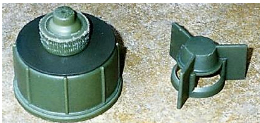
ФОТО 6.68. Противопехотная мина фугасного действия Mi-AP-DN-59 (или Inkstad) (Франция)
