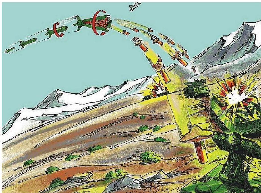
ФОТО 12.6. Принцип действия СБУ-105 (контейнер СБУ-87 с комплектом наведения WCMD), наполнявшихся осколочно-зажигательно-кумулятивными боеприпасами BLU-97
