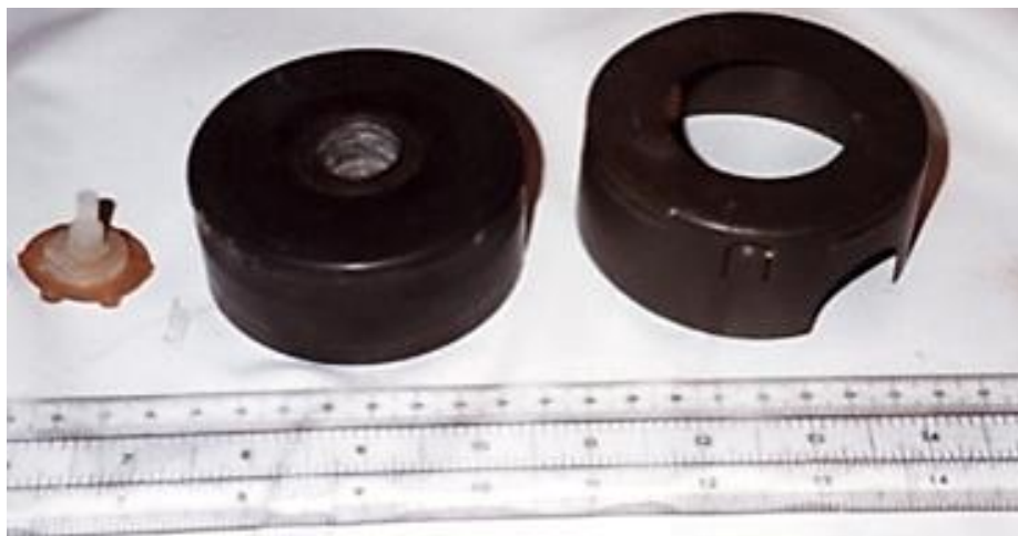
ФОТО 6.51. Противопехотная мина фугасного действия LI-11
