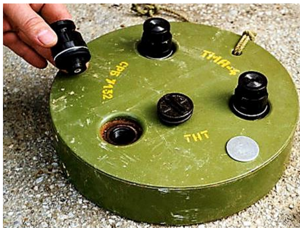
ФОТО 6.108. Противотанковая противогусеничная мина ТМА-4
