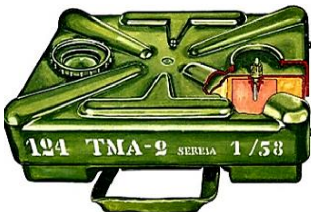
ФОТО 6.102. Противотанковая противогусеничная мина ТМА-2
