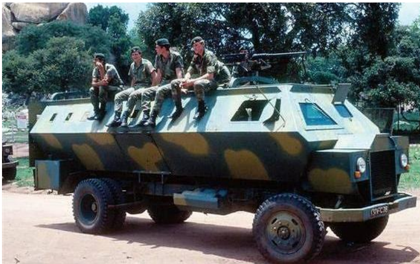
ФОТО 11.6. Южнородезийский броневедомитель Kudu, созданный на шасси автомобиля Land Rover
