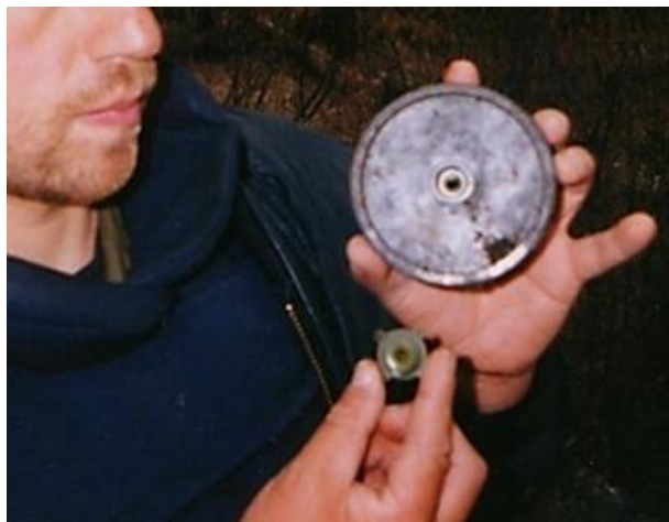
ФОТО 6.65. Установка взрывателя УПМАХ-3 в мину ПМА-3 / Олег Валецкий
