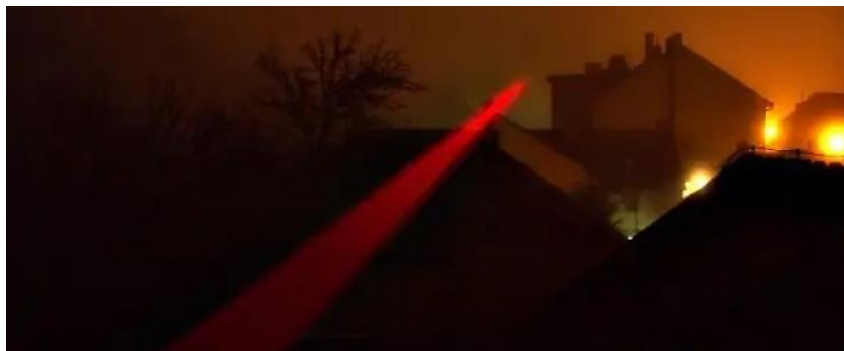
ФОТО 12.19. Пример рассеивания лазерного луча в туманную погоду
